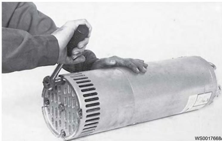
Для того чтобы насос обеспечивал максимальную подачу, рабочее колесо необходимо периодически регулировать.
