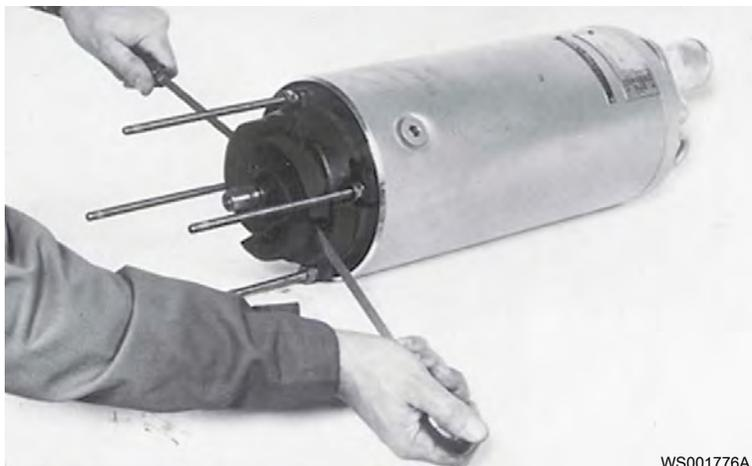
д) Снимите регулировочные шайбы.
